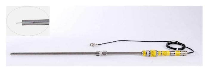
注意:工作样品需与导线进行点焊连接
